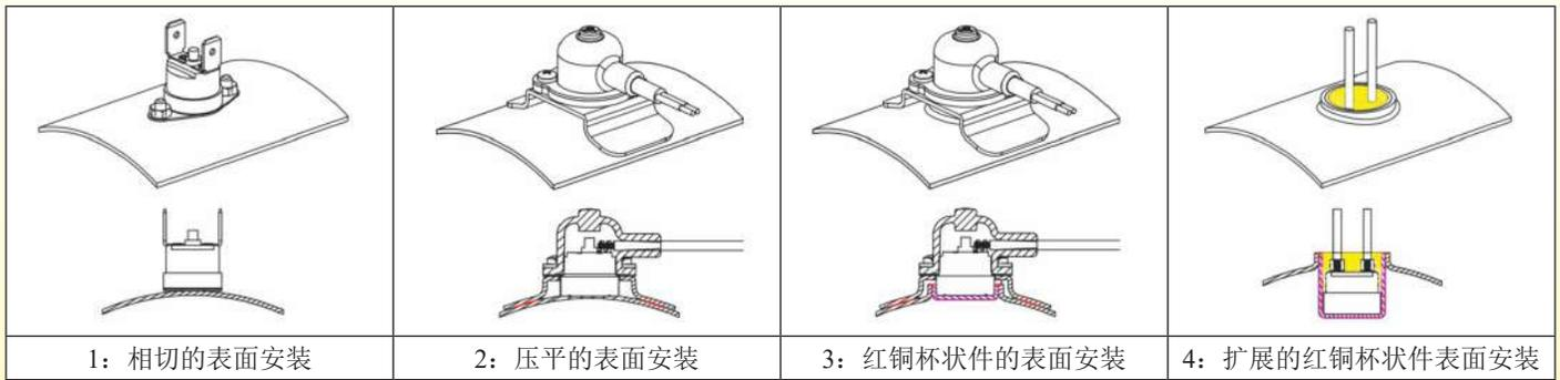
在正常的工作条件下，通过加热器的液体的流动温度是稳定的，因为它是由一个温控器控制。如同限温器的安全设备不跳闸。为了寻找最佳的限温器的位置和安装，当发生过热时，测量它们的反应时间是很重要的。因此，根据两种可能的故障，我们在两种不同的操作条件下进行测试。
