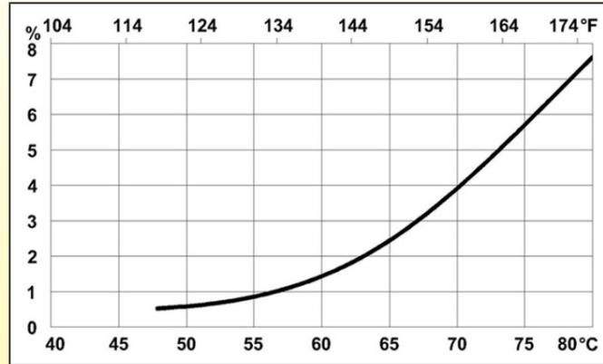
这些数据表明稀释于循环水的矿物盐的预计比例，将会沉淀在与管状加热器热壁接触的地方。可以看到温度范围 60-65°C是极重要的位置，那里是沉淀物开始增加地方。
