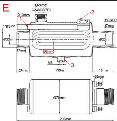
管状加热器的直径：8mm
