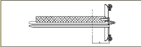
安装在冲压法兰上是可移动加热器的一个经济的解决方案，因为它允许有大的直径，以及镁牺牲阳极的安装。它允许容易地从罐中除去加热器，以便能够进行清洁，除去沉淀物和水垢，并更换阳极。
