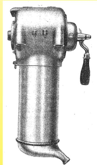
1922年，巴黎Presto公司开发一种水龙头安装快热式热水器，其中水是通过自己的传导性来加热的，不带发热线。这技术解决方案，其缺陷是对水质非常敏感，仍用于在机械上产生蒸汽以去掉壁纸及类似的设备。（Ultimheat博物馆文件）。
