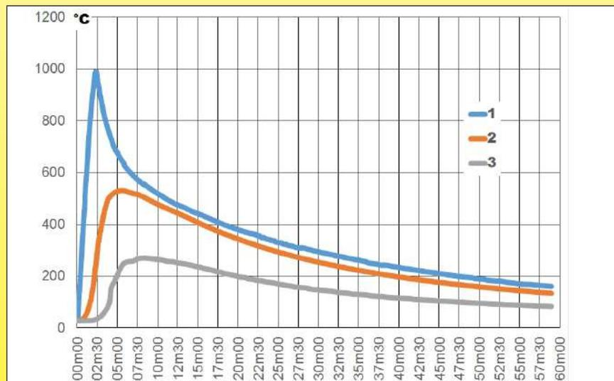
对直径125mm液体加热器进行的测试，配备3个2kw的管式加热器，表面负载**10W/cm<sup>2</sup>**，20mm NBR-PVC泡沫隔热和镀铝护套。**罐壁温度升至520°C以上。**
