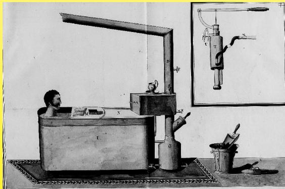
1820：浴缸加热同样也是当时研究员的兴趣集中点之一。巴黎的比才先生，通过热虹吸系统（INPI专利）发明了加热的浴缸，与罗马人所使用的那种非常接近。煤，在巴黎变得广泛地被使用，用于加热锅炉。
