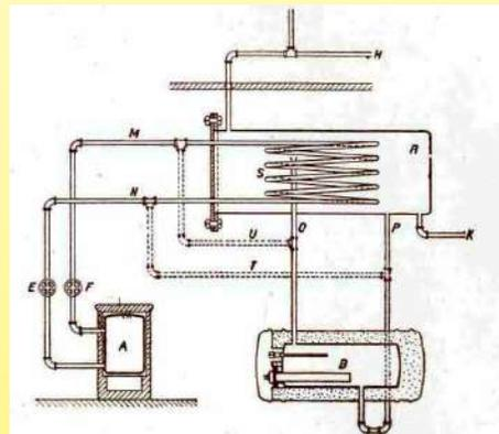
自1925以来Etelec制造1928“Electro-cumul”电热水器，建立了Etablissement électromécaniques de Strasbourg公司。加热器是单管型，在盘卷的发热线上带有陶瓷圆桶。水被加热到95°C。（Ultimheat博物馆）
