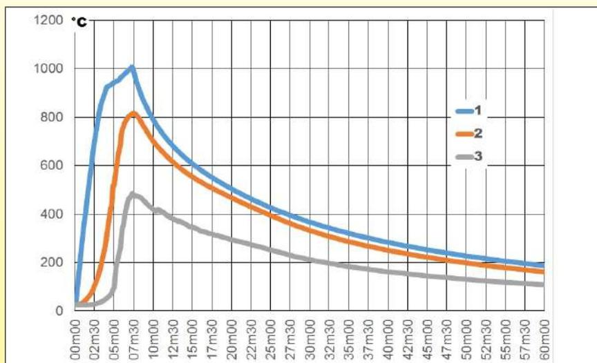
在直径125mm的液体加热器进行测试，带有每个1kw的3个管状加热器，表面载荷**5W/cm<sup>2</sup>**，有20mm NBR-PVC泡沫热绝缘，及铝覆盖的护套。**罐壁温度上升超过 800°C。**
