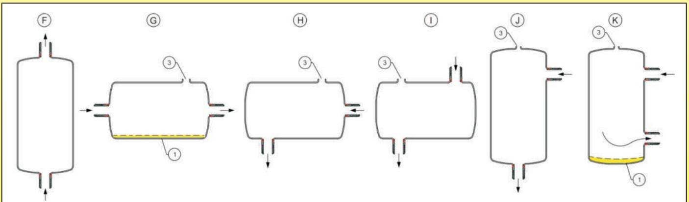
图纸中的F、H、I、J展示了带有圆角的设计。通过位置（F），或气孔（3）的存在避免了空气凹位。如果按照流向流动的，可避免污物沉积。附图G和K展示了污物沉积的危险，并可能在最低部（1）要求要有一个排放孔。
