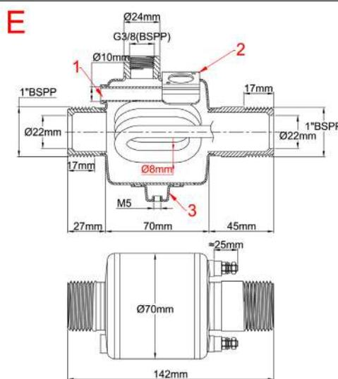
管状加热器的直径：8mm
