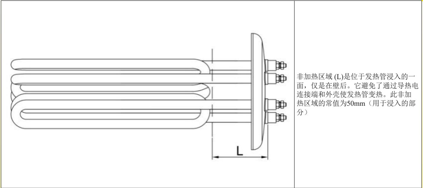
非加热区域(L)是位于发热管浸入的一面，仅是在壁后。它避免了通过导热电连接端和外壳使发热管变热。此非加热区域的常值为50mm（用于浸入的部分）
