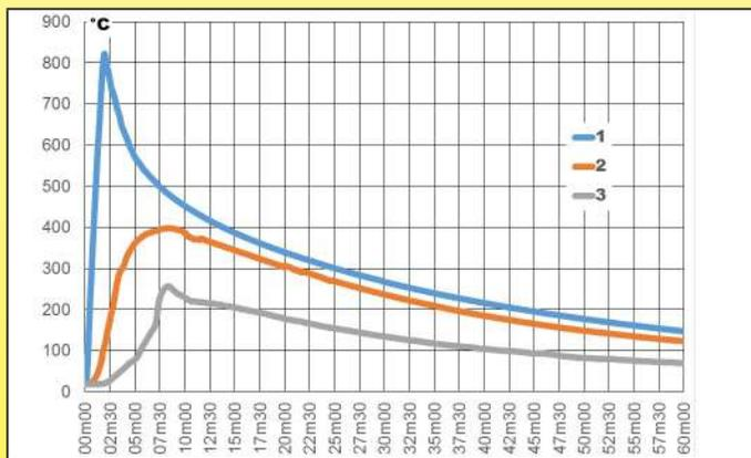
在直径125mm的液体加热器进行测试，带有每个2kw的3个管状加热器，表面载荷10W/cm²，有20mm NBR-PVC泡沫热绝缘，及铝覆盖的护套，122°C熔断器。
