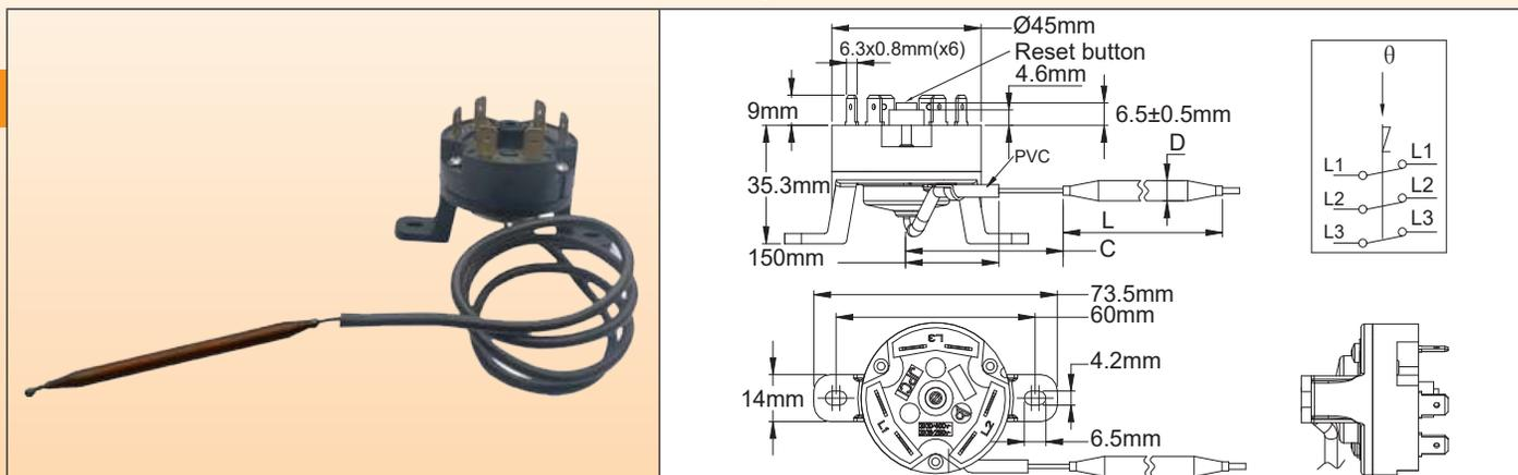
**应用：**避免加热器由于流量故障导致液体温度上升出现异常而过热。球管的安装可在标准的直径8.5mm的探温棒内进行，或者可根据要求在附加的热电偶套管内进行。温控器主体可被安装在发热管输出的保护盖子内，或者在远处单独分开的控制箱内。跳闸后，它们可被重设，但是先对电路进行全面的检查是很关键的，以查找出过热的原因并且在重启后作出修正。
