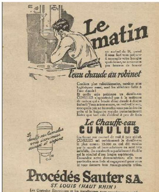
1917年由于上述瑞士市场的有利环境，一名瑞士工程师，弗里茨索泰在1910年研发了一台自动开关电器系统来使用夜间费率，发明了一种名为“积云”的电贮水式加热器，其名字后来被杜撰成法语，用于电贮水式加热器。1922年开始在法国销售，当时索泰在圣路易建立他的法国工厂。罐体是用软木颗粒来进行隔热的。
