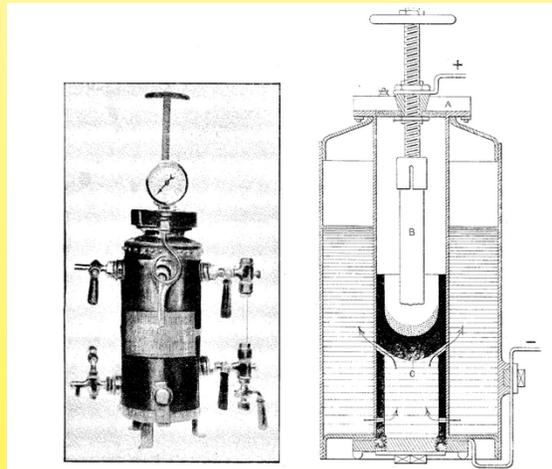
1900年，第一个电锅炉似乎是俄罗斯工程师奥格林莫夫，将其展示在世界博览会上。他称这种装置为“Calorifacteur électrique”。它是通过在两个电极之间产生一个电弧来操作的，特别被用于产生蒸汽。1923年，瑞士公司欧瑞康开始制造类似的电锅炉，在Revel名下称为电极加热锅炉。该技术方案是用以产生蒸汽和热水，仍有一些公司在生产，主要用于大功率的锅炉。
