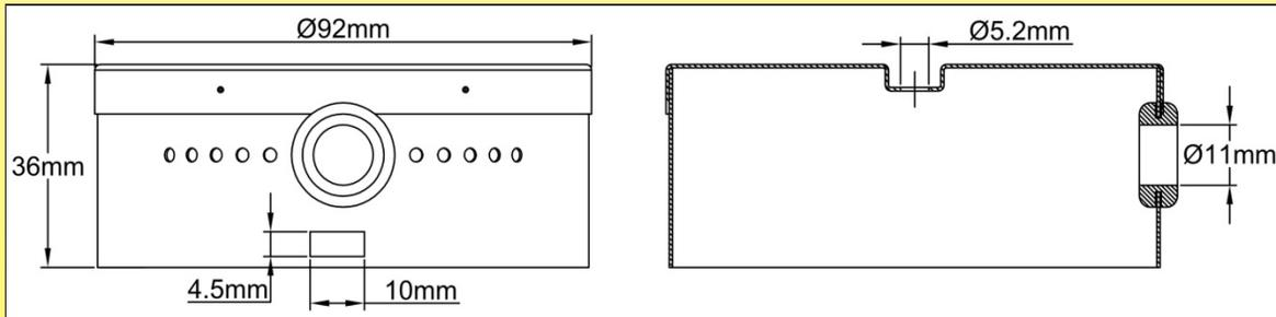
为了保护电气端子免受震动，可随意地安装一个不锈钢盖子在输出法兰上。用一个螺丝和一个钩将它固定在接地端子里。它不提供防水滴保护。
