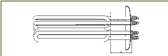
在一个封闭回路中的低矿化水的循环，并在低腐蚀性的液体中，最经济的解决方案，然而管状加热器直接焊接在罐壁上。当使用高质量的管状加热器时，具有良好的电绝缘性，此组件将具有数年的寿命，类似于其他的两种解决方案，成本更加低。
