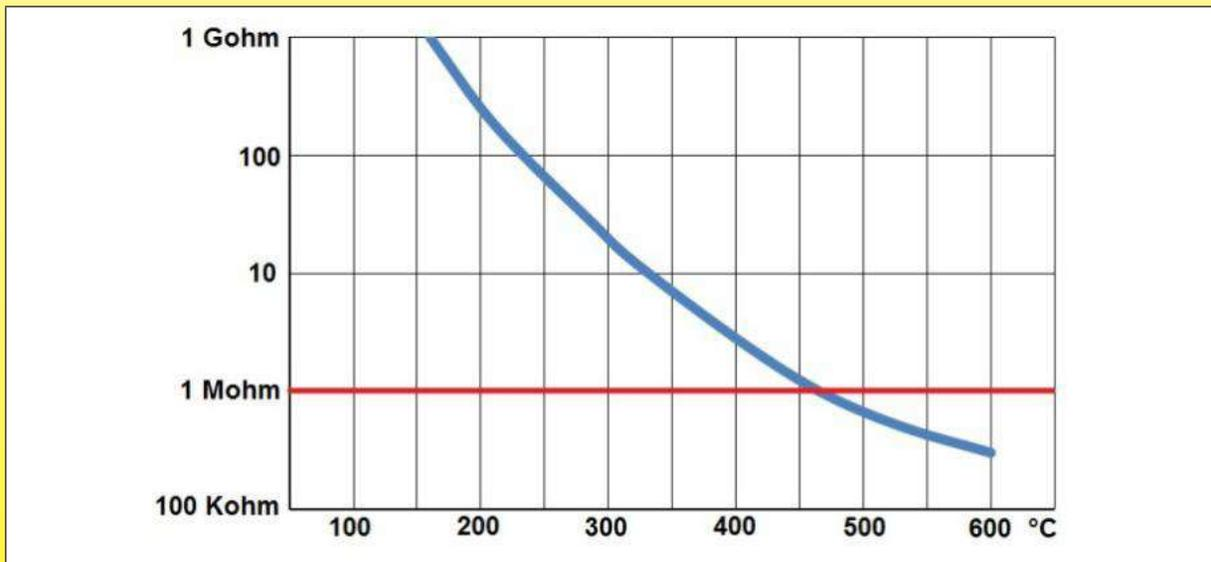
直径8mm，长度1200mm铠装式管状加热器的绝缘值对温度的对比。（在一个烤箱里测量，在没密封的末端事先脱水的铠装式管状加热器上进行）
