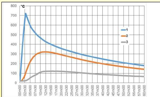
在直径125mm的液体加热器进行测试，带有每个2kw的3个管状加热器，表面载荷5W/cm²，有20mm NBR-PVC泡沫热绝缘，及铝覆盖的护套，122°C熔断器。
